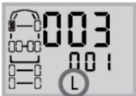
首先显示的是左前轮传感发射器的高6位ID码，英文字母“H”，用来指示这是传感发射器ID码高6位，按S键可以查看低六位ID码。“L”表示显示的是低6位ID码。继续按S键可查看其他轮胎传感发射器的ID码。
