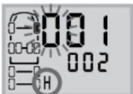
在右前轮传感发射器ID码查看状态长按E键达3秒，进入修改状态，第一个数字开始闪烁。按S键调整该数值，按E键进入下一位数字的设置。
