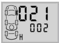
按照上述步骤设置好所有12位ID码，长按E键约3秒，设定的ID码将被保存。蜂鸣器短促鸣叫两声，之后返回到查看ID码状态。若在修改状态长按S键会放弃当前修改的数值回到设置菜单索引。
