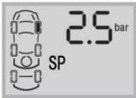
按照上述步骤设置好标准压力值后，长按E键约3秒，设定的值将会被保存，蜂鸣器连续鸣叫两声，之后返回到查看标准压力状态。
