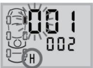
在右前轮传感发射器ID码查看状态长按E键达3秒，进入修改状态，第一个数字开始闪烁。按S键调整该数值，按E键进入下一位数字的设置。
