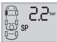
按S键切换到索引界面“-2-”，再按E键进入标准压力查询界面。首先显示左前轮胎的标准压力值，出厂时默认设置为32psi。
