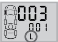
首先显示的是左前轮传感发射器的高6位ID码，英文字母“H”，用来指示这是传感发射器ID码高6位，按S键可以查看低六位ID码。“L”表示显示的是低6位ID码。继续按S键可查看其他轮胎传感发射器的ID码。
