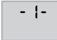
在中央监控器正常运行模式下，长按E键约3秒可进入中央监控器设置索引界面，显示“-1-”表示索引界面1。
