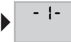
在中央监控器正常运行模式下，长按E键约3秒可进入中央监控器设置索引界面，显示“-1-”表示索引界面1。
