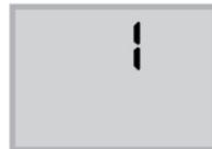
在正常运行模式下，长按E键约3秒进入中央监控器设置界面，显示索引界面“\_1\_”，再按E键进入传感发射器ID码查看界面。
