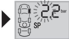
在标准压力查询状态下，长按E键约3秒进入标准压力设置状态，此时第一位数字闪烁。
