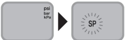
按 (S) 键在“压力单位”、“标准压力设置”和“轮胎换位”中切换。当选择“标准压力设置”时，“SP”标志开始闪烁。
