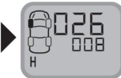
长按 (E) 键3秒进入ID码设置界面，此时安装在左前轮上的传感发射器的前6位ID码出现在屏幕上。
