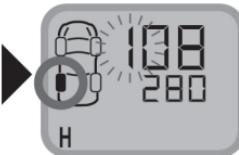
按 (S) 键循环查看每个轮胎的传感器ID码，当需要更换的传感器的前6位ID码出现在屏幕上时，长按 (E) 键3秒进入ID码设置模式，此时传感器的前6位ID码的第一位开始闪烁。
