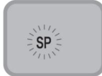
在正常工作模式下，长按 (E) 键3秒进入中央监控器设置界面。然后按 (S) 键切换到“标准压力设置”界面，此时“SP”标志闪烁。
